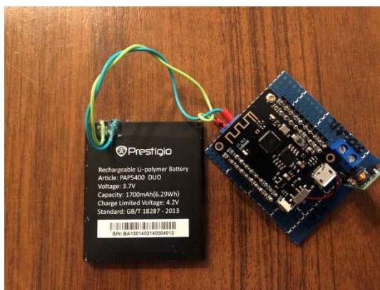
Рисунок 3.7 - Система зарядки литий-ионной батареи
