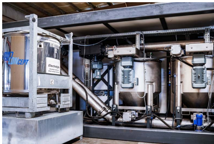
Рисунок 2.6 - Восстановленный электролит в контейнере для сбора
